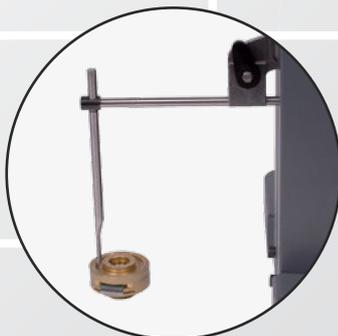
Mesure de profondeur avec accessoires
