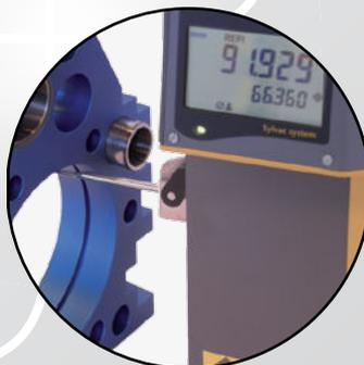
Mesure de diamètre intérieur avec
